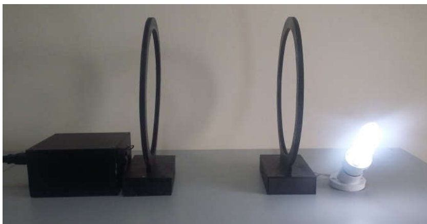
Hình 6. Kết quả mô hình thực nghiệm của hệ thống truyền điện không dây
