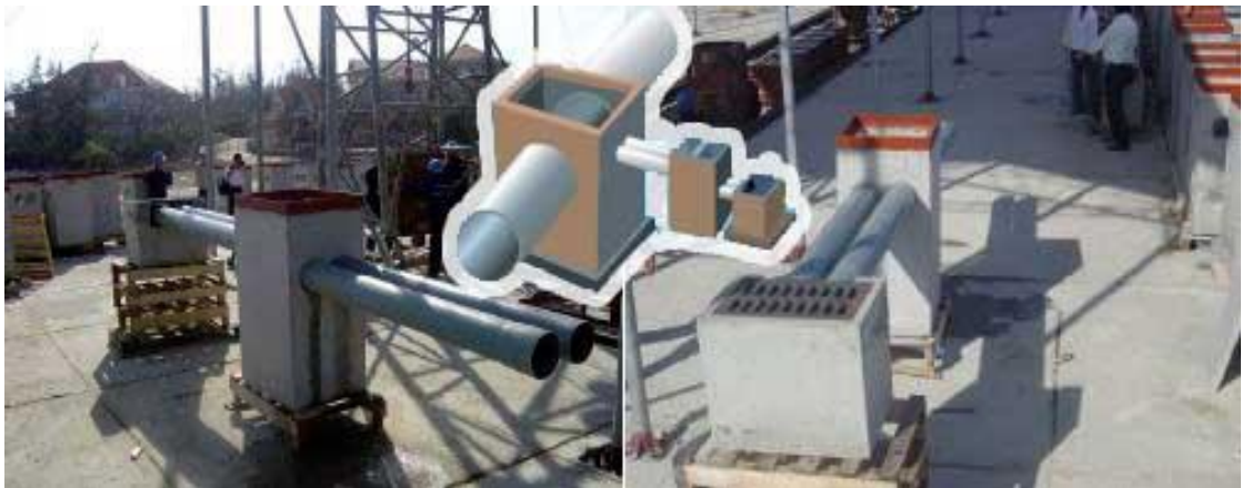
Hình 6. Mô hình và dây chuyền sản xuất hệ thống ga thu ngăn mùi của BUSADCO
