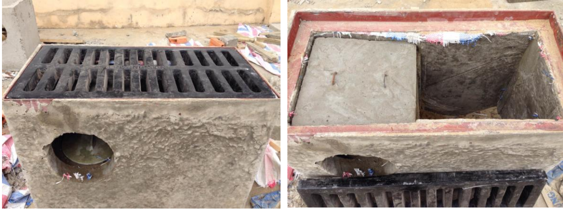
Hình 9. Sản xuất thử nghiệm ga thu bằng BTCT M250
