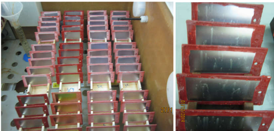
Hình 2. Mẫu thử động trước phun muối và khí xuất hiện gỉ trắng
