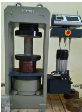
Hình 5. Thí nghiệm nén mẫu bê tông
